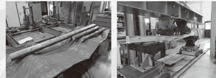
(左)安来市役所から提供されたコウヨウザンの原木 (右)強度試験の様子(角材寸法:10.5×10.5×250センチメートル)
