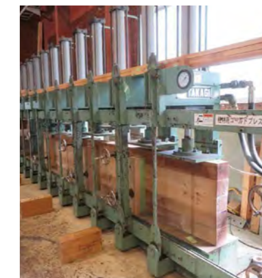
プレス機による接着作業
