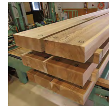
接着重ね材 (スギ心去り材3本を接着した例)
