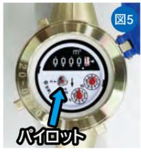
●漏水が疑われるときは、屋内の全ての蛇口を閉めた状態で、水道メーターのパイロット(銀色のコマ)を確認する(図5)
