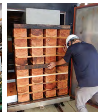
スギ心去り平角試験体の乾燥試験
