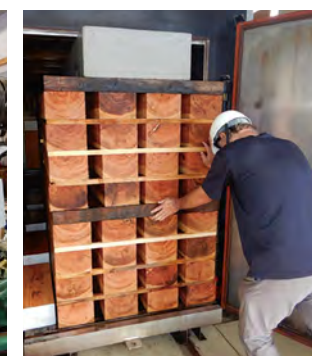
スギ心去り平角試験体の乾燥試験
